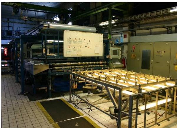
Über den Lagerbereich gelangt man zu der Qualitätskontrolle. Hier wird die Produktion des Wasserbad- und des Kammerverfahrens kontrolliert und anschließend mit einer Schutzfolie kaschiert.
