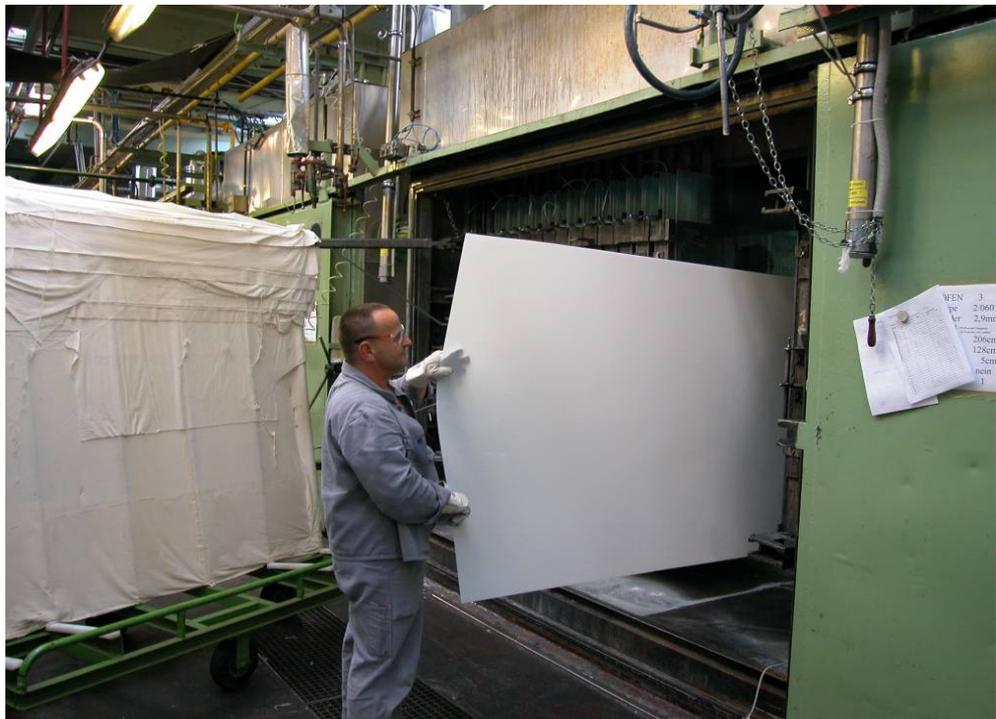
Abb. 7: Entformung aus einer Kammer
