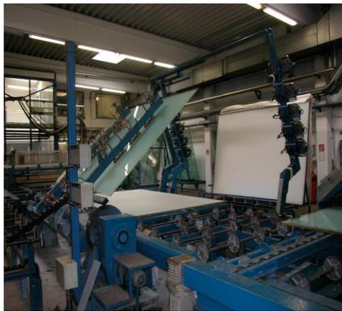
Bevor man die so entstandene Acrylglasplatte mit einer Schutzfolie versieht, wird diese einer strengen Qualitätskontrolle unterzogen.
